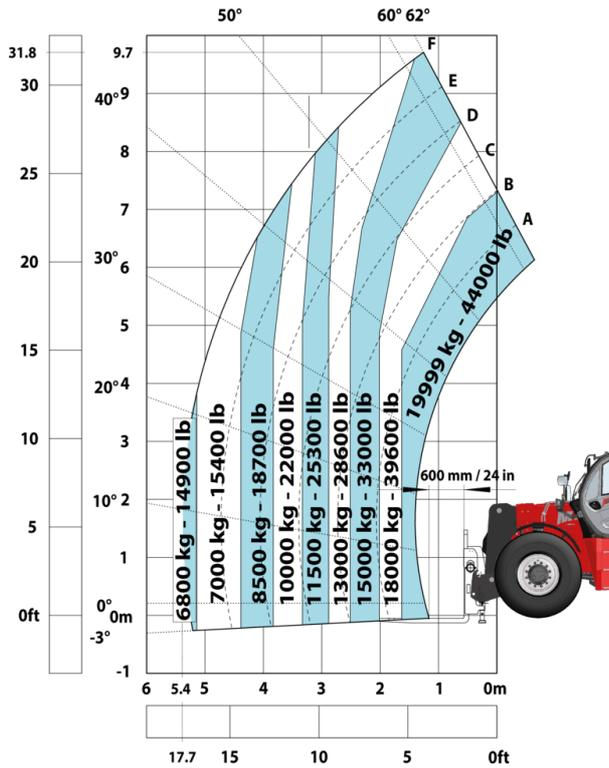
Machine sur pneus avec fourches CDG 600 mm (Impérial)
