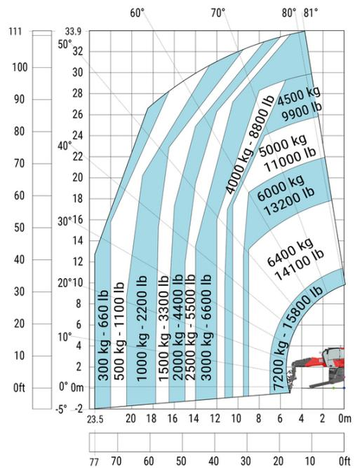
Machine sur stabilisateurs abaissés avec potence 1500 kg Machine sur stabilisateurs abaissés avec potence 1500 kg
