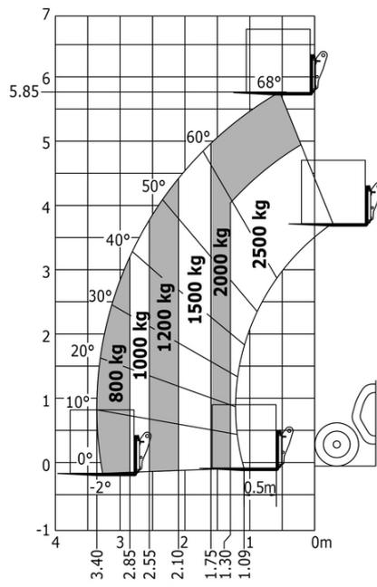
Machine sur pneus avec fourches Impérial
